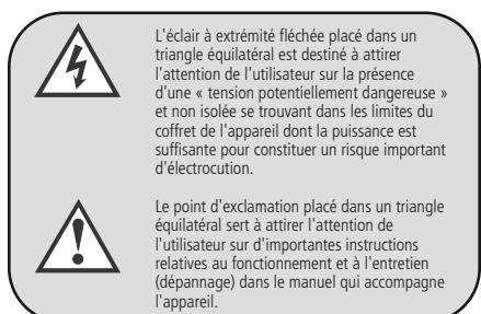
L'éclair à extrémité fléchée placé dans un triangle équilatéral est destiné à attirer l'attention de l'utilisateur sur la présence d'une « tension potentiellement dangereuse » et non isolée se trouvant dans les limites du coffret de l'appareil dont la puissance est suffisante pour constituer un risque important d'électrocution.
