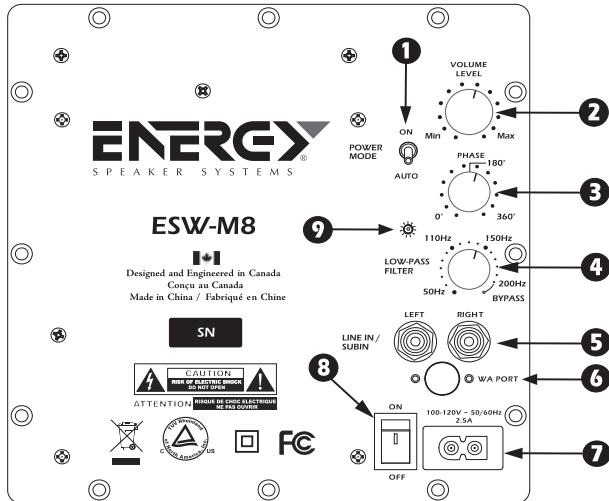
**⑦ POWER CORD CONNECTOR** (电源线接孔) - 将电源线从 AC 插座联接到此输入接孔。我们建议您始终将低音音箱连在电涌防护器或电源净化器上。请不要将电源线联接到接收器带开关或不带开关的插座上，以防损坏低音音箱和接收器。
